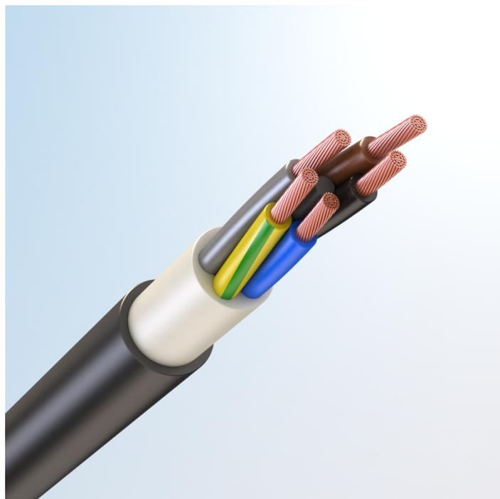
Кабель силовой гибкий, с медными токопроводящими жилами, с изоляцией из высокопрочной этиленпропиленовой резины HEPR, с наружной оболочкой из хладостойкой высокопрочной этиленпропиленовой резины HEPR пониженной пожарной опасности, не содержащей галогенов
