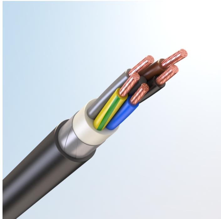
Кабель силовой, с медными токопроводящими жилами, с изоляцией из высокопрочной этиленпропиленовой резины НЕРР, бронированный алюминиевыми лентами или лентами из алюминиевого сплава, с наружной оболочкой из поливинилхлоридного пластика пониженной пожарной опасности, с низким дымо- и газовыделением
