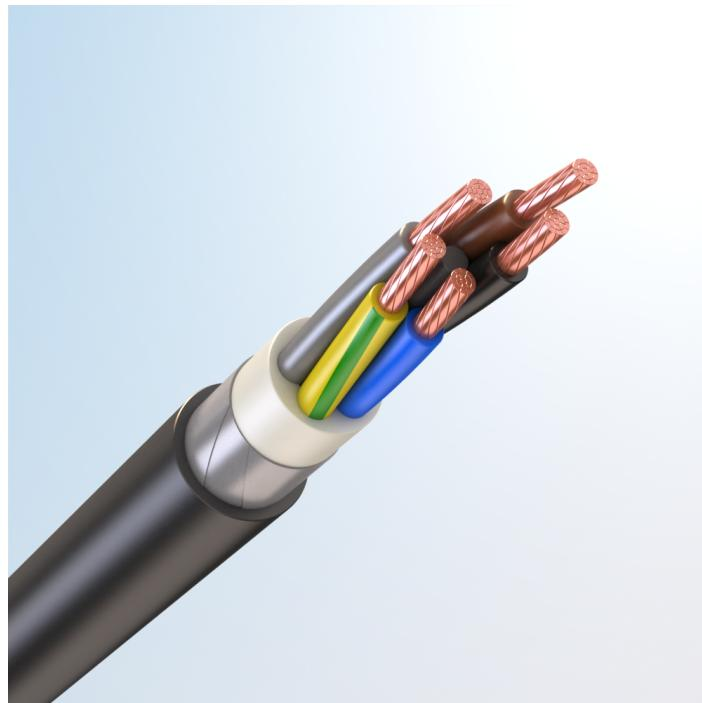
Кабель силовой, с медными токопроводящими жилами, с изоляцией из высокопрочной этиленпропиленовой резины НЕPR, бронированный алюминиевыми лентами или лентами из алюминиевого сплава, с наружной оболочкой из высокопрочной этиленпропиленовой резины НЕPR пониженной пожарной опасности
