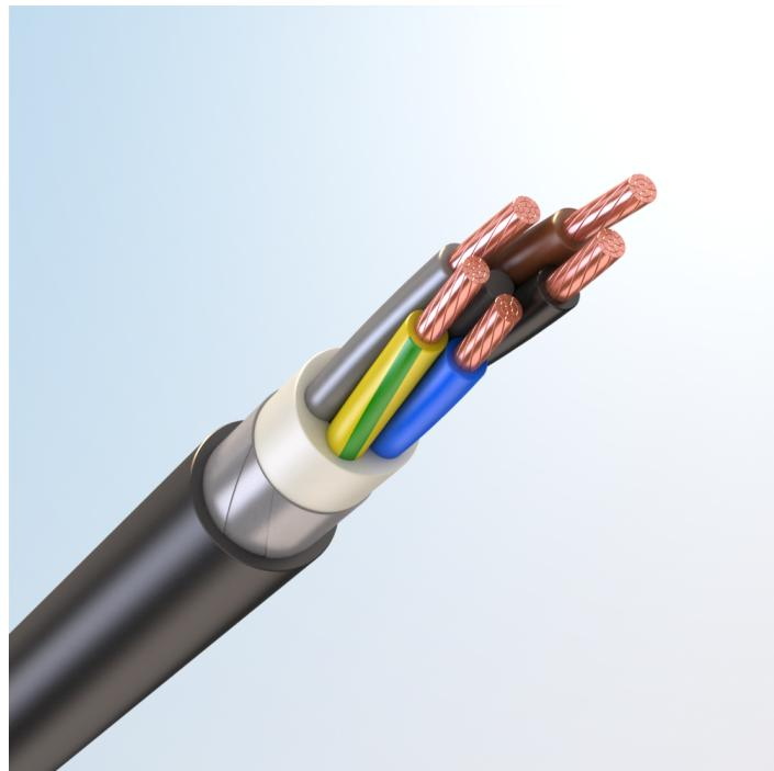
Кабель силовой, с медными токопроводящими жилами, с изоляцией из высокопрочной этиленпропиленовой резины НЕРР, бронированный стальными оцинкованными лентами, с наружной оболочкой из хладостойкого поливинилхлоридного пластика пониженной пожарной опасности, с низким дымо- и газовыделением
