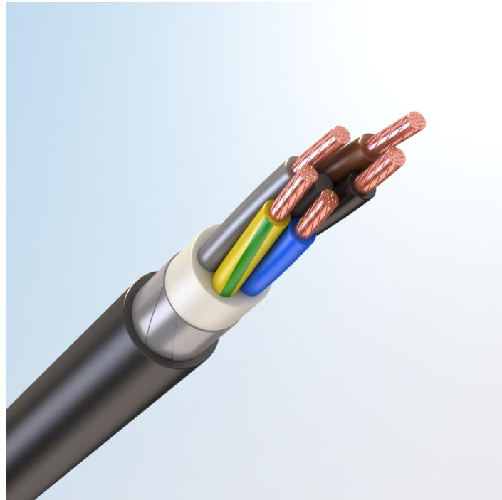
Кабель силовой, с медными токопроводящими жилами, с изоляцией из высокопрочной этиленпропиленовой резины НЕРР, бронированный стальными оцинкованными лентами, с наружной оболочкой из хладостойкого поливинилхлоридного пластика пониженной пожарной опасности
