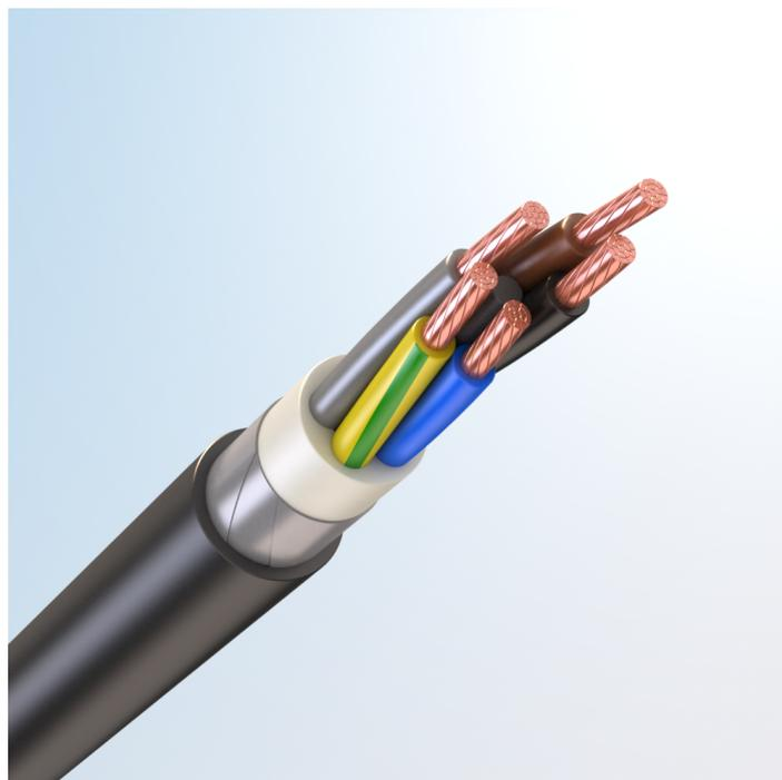
Кабель силовой, с медными токопроводящими жилами, с изоляцией из высокопрочной этиленпропиленовой резины HEPR, бронированный стальными оцинкованными лентами, с наружной оболочкой из высокопрочной этиленпропиленовой резины HEPR пониженной пожарной опасности, не содержащей галогенов
