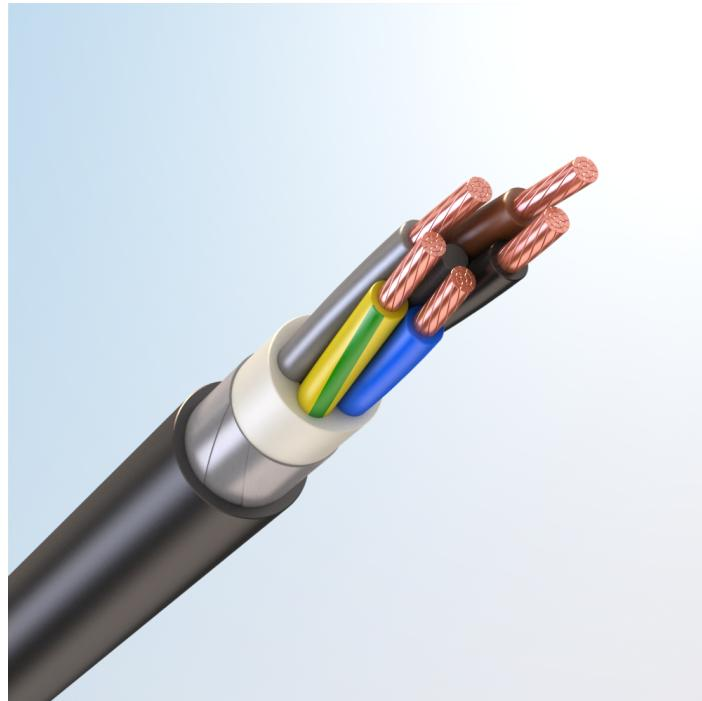
Кабель силовой, с медными токопроводящими жилами, с изоляцией из высокопрочной этиленпропиленовой резины НЕРР, бронированный стальными оцинкованными лентами, с наружной оболочкой из термопластичного эластомера пониженной пожарной опасности
