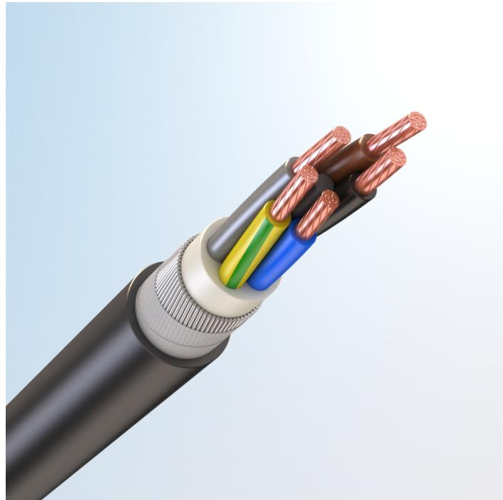
Кабель силовой, с медными токопроводящими жилами, с изоляцией из высокопрочной этиленпропиленовой резины НЕPR, с наружной оболочкой из полимерной композиции пониженной пожарной опасности, не содержащей галогенов
