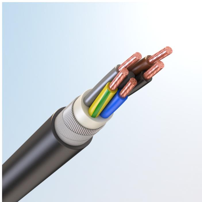
Кабель силовой, с медными токопроводящими жилами, с изоляцией из высокопрочной этиленпропиленовой резины NEPR, с наружной оболочкой из хладостойкой полимерной композиции пониженной пожарной опасности, не содержащей галогенов
