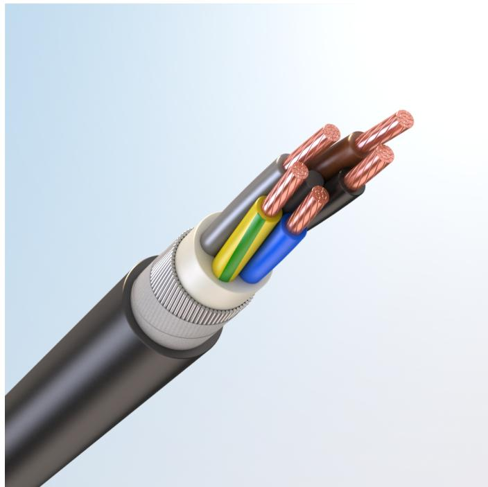
Кабель силовой, с медными токопроводящими жилами, с изоляцией из высокопрочной этиленпропиленовой резины НЕПР, с наружной оболочкой из высокопрочной этиленпропиленовой резины НЕПР пониженной пожарной опасности
