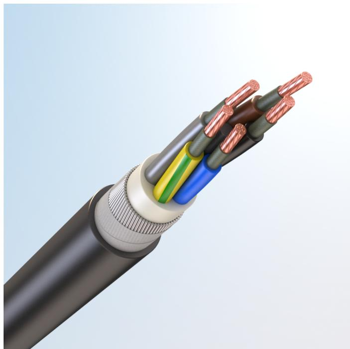
Кабель силовой, огнестойкий, с медными токопроводящими жилами, с обмоткой по токопроводящим жилам слюдосодержащей лентой, с изоляцией из высокопрочной этиленпропиленовой резины HEPR, с наружной оболочкой из высокопрочной этиленпропиленовой резины HEPR пониженной пожарной опасности, не содержащей галогенов
