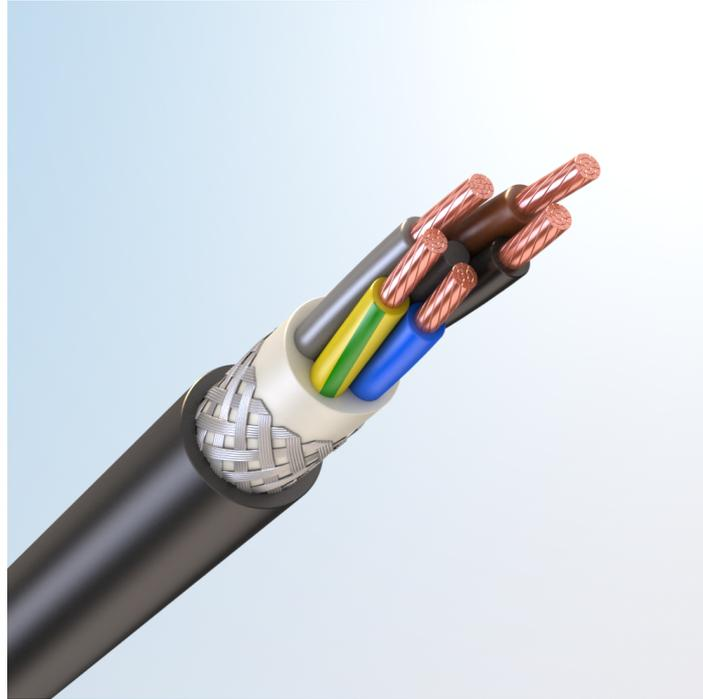
Кабель силовой, с медными токопроводящими жилами, с изоляцией из высокопрочной этиленпропиленовой резины NEPR, бронированный стальными оцинкованными проволоками в виде оплетки, с наружной оболочкой из полимерной композиции пониженной пожарной опасности, не содержащей галогенов
