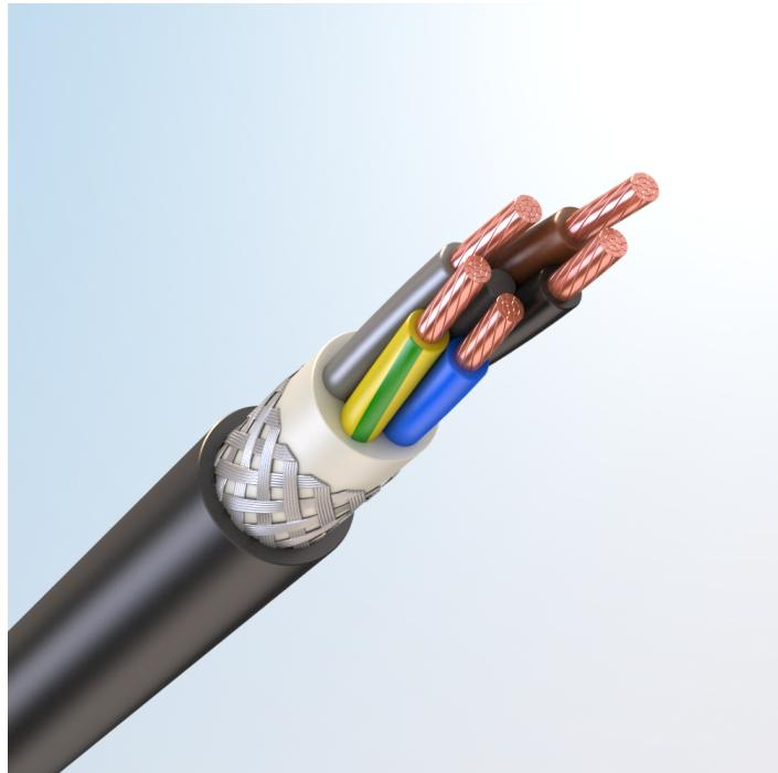
Кабель силовой, с медными токопроводящими жилами, с изоляцией из высокопрочной этиленпропиленовой резины НЕPR, бронированный стальными оцинкованными проволоками в виде оплетки, с наружной оболочкой из высокопрочной этиленпропиленовой резины НЕPR пониженной пожарной опасности
