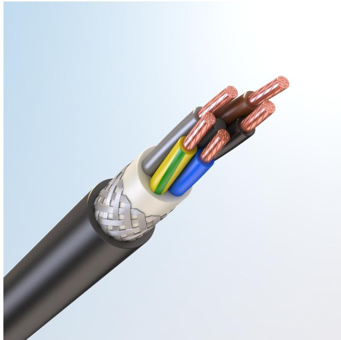
Кабель силовой, с медными токопроводящими жилами, с изоляцией из высокопрочной этиленпропиленовой резины НЕPR, бронированный стальными оцинкованными проволоками в виде оплетки, с наружной оболочкой из высокопрочной этиленпропиленовой резины НЕPR пониженной пожарной опасности, не содержащей галогенов
