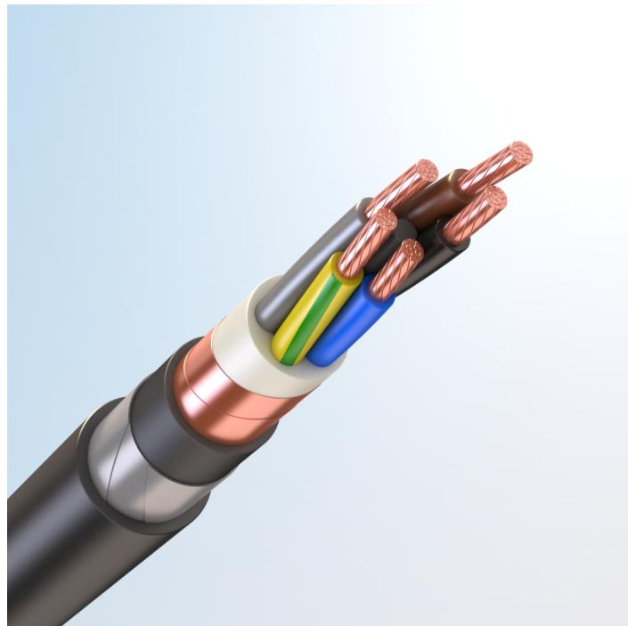
Кабель силовой, с медными токопроводящими жилами, с изоляцией из высокопрочной этиленпропиленовой резины НЕРР, с общим экраном из медной фольги или медной проволоки, бронированный стальными оцинкованными лентами, с наружной оболочкой из поливинилхлоридного пластика пониженной пожарной опасности
