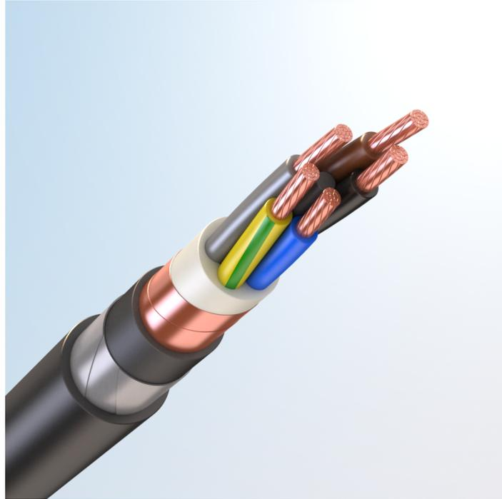
Кабель силовой, с медными токопроводящими жилами, с изоляцией из высокопрочной этиленпропиленовой резины NEPR, с общим экраном из медной фольги или медной проволоки, бронированный стальными оцинкованными лентами, с наружной оболочкой из хладостойкого поливинилхлоридного пластиката пониженной пожарной опасности, с низким дымо- и газовыделением
