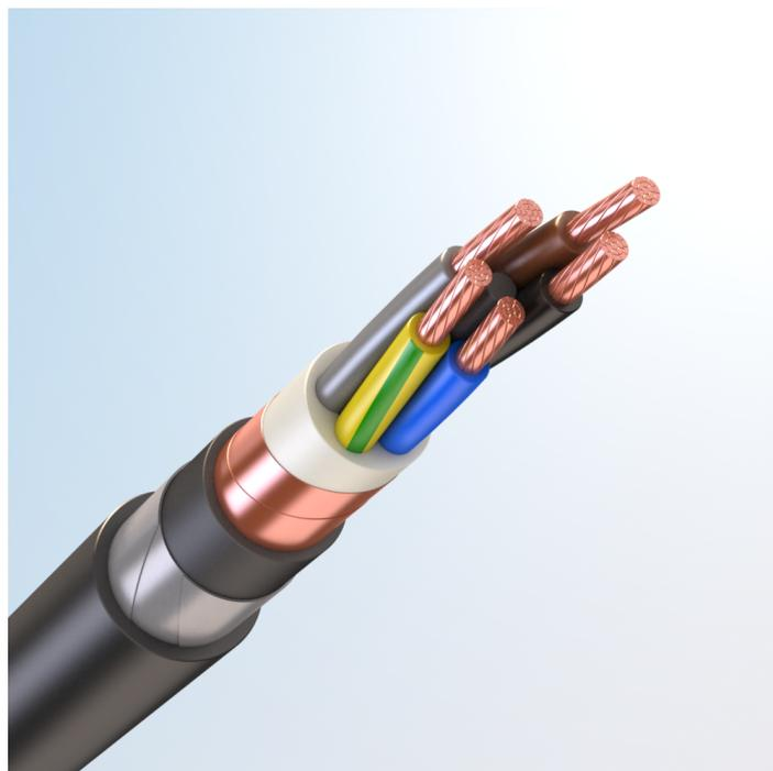
Кабель силовой, с медными токопроводящими жилами, с изоляцией из высокопрочной этиленпропиленовой резины HEPR, с общим экраном из медной фольги или медной проволоки, бронированный стальными оцинкованными лентами, с наружной оболочкой из высокопрочной этиленпропиленовой резины HEPR пониженной пожарной опасности, не содержащей галогенов
