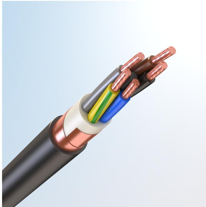
Кабель силовой, с медными токопроводящими жилами, с изоляцией из высокопрочной этиленпропиленовой резины НЕР, с общим экраном из медной фольги или медной проволоки, с наружной оболочкой из поливинилхлоридного пластика пониженной пожарной опасности
