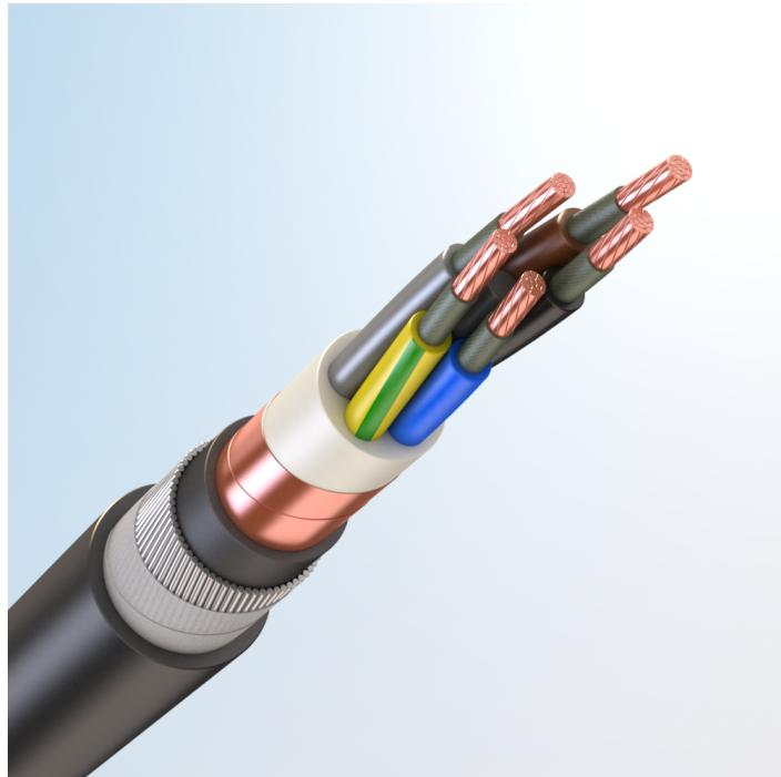
Кабель силовой, с медными токопроводящими жилами, с изоляцией из высокопрочной этиленпропиленовой резины НЕPR, с общим экраном из медной фольги или медной проволоки, бронированный стальными оцинкованными проволоками, с наружной оболочкой из поливинилхлоридного пластика пониженной пожарной опасности, с низким дымо- и газовыделением
