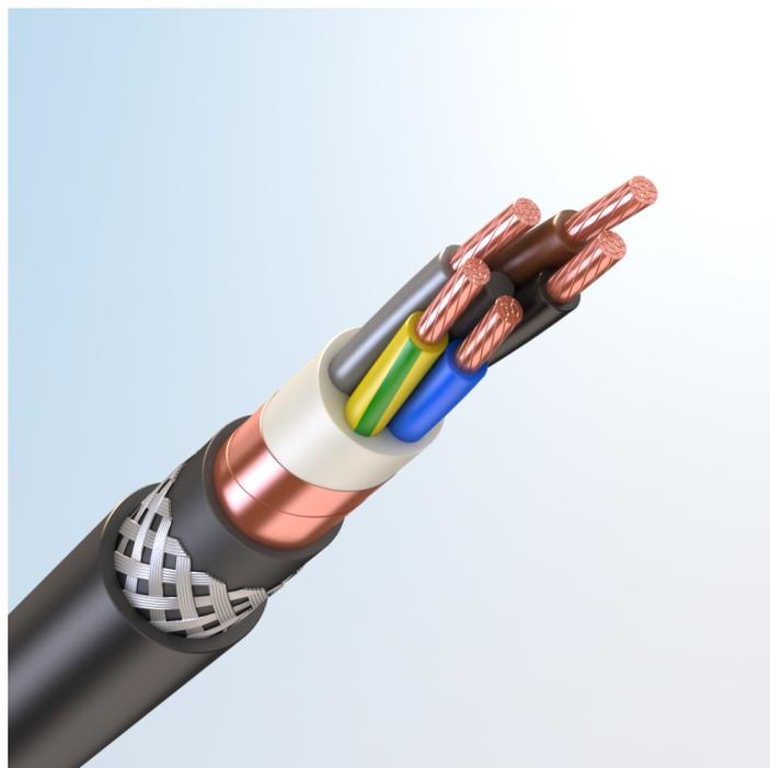
Кабель силовой, с медными токопроводящими жилами, с изоляцией из высокопрочной этиленпропиленовой резины НEPR, с общим экраном из медной фольги или медной проволоки, бронированный стальными оцинкованными проволоками в виде оплетки, с наружной оболочкой из хладостойкого поливинилхлоридного пластика пониженной пожарной опасности, с низким дымо- и газовыделением
