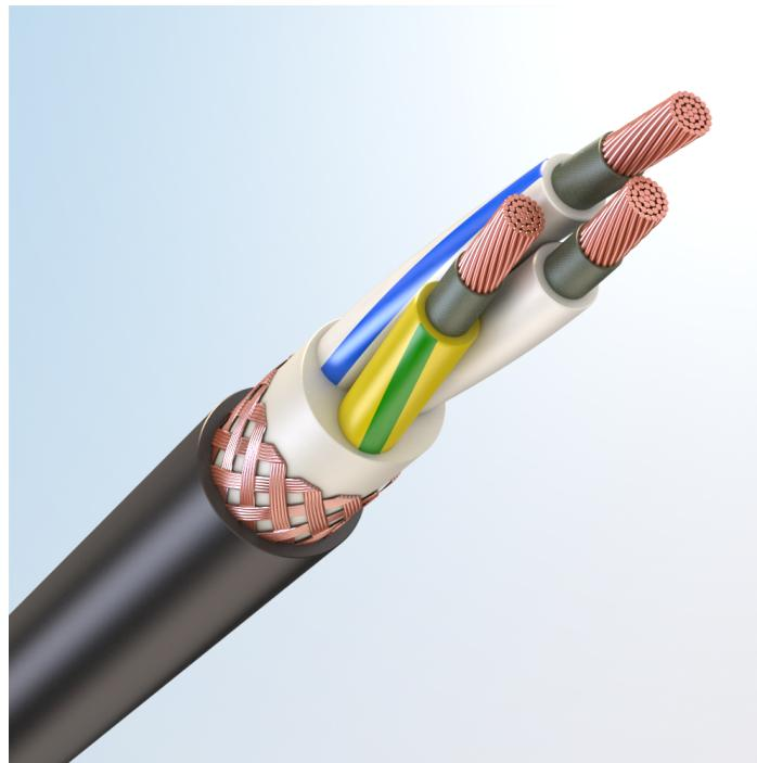
Кабель силовой, огнестойкий, с медными токопроводящими жилами, с обмоткой по токопроводящим жилам слюдосодержащей лентой, с изоляцией из высокопрочной этиленпропиленовой резины НЕPR, с общим экраном из медной фольги или медной проволоки, с наружной оболочкой из хладостойкой высокопрочной этиленпропиленовой резины НЕPR пониженной пожарной опасности, не содержащей галогенов
