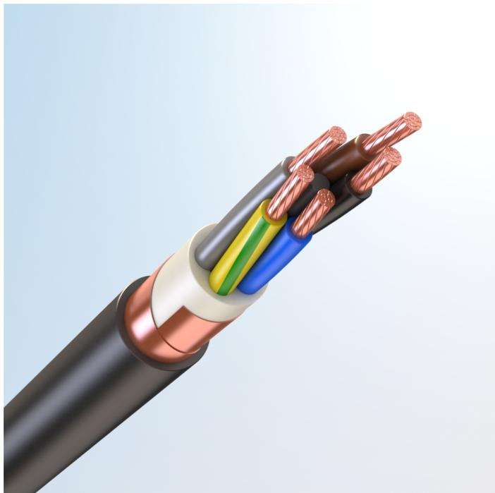
Кабель силовой, с медными токопроводящими жилами, с изоляцией из высокопрочной этиленпропиленовой резины NEPR, с общим экраном из медной фольги или медной проволоки, с наружной оболочкой из хладостойкой высокопрочной этиленпропиленовой резины NEPR пониженной пожарной опасности, не содержащей галогенов
