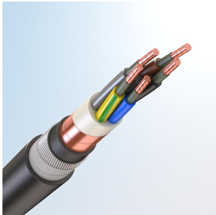
Кабель силовой, с медными токопроводящими жилами, с изоляцией из высокопрочной этиленпропиленовой резины НЕPR, с общим экраном из медной фольги или медной проволоки, бронированный стальными оцинкованными проволоками, с наружной оболочкой из хладостойкой высокопрочной этиленпропиленовой резины НЕPR пониженной пожарной опасности, не содержащей галогенов
