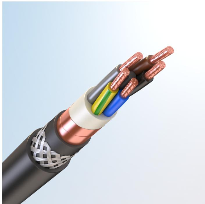
Кабель силовой, с медными токопроводящими жилами, с изоляцией из высокопрочной этиленпропиленовой резины НЕРР, с общим экраном из медной фольги или медной проволоки, бронированный стальными оцинкованными проволоками в виде оплетки, с наружной оболочкой из поливинилхлоридного пластика пониженной пожарной опасности
