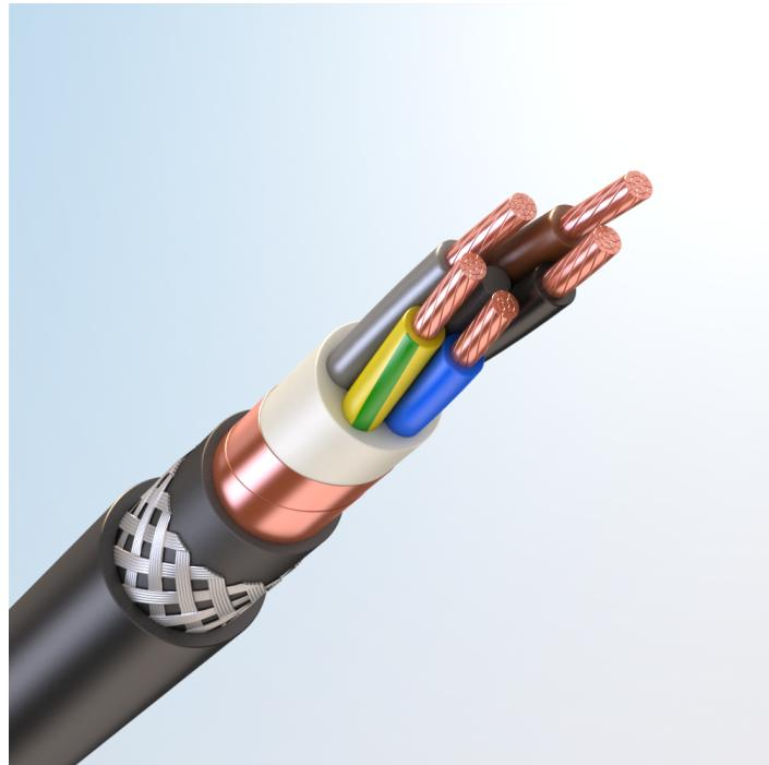
Кабель силовой, с медными токопроводящими жилами, с изоляцией из высокопрочной этиленпропиленовой резины НЕPR, с общим экраном из медной фольги или медной проволоки, бронированный стальными оцинкованными проволоками в виде оплетки, с наружной оболочкой из поливинилхлоридного пластика пониженной пожарной опасности, с низким дымо- и газовыделением
