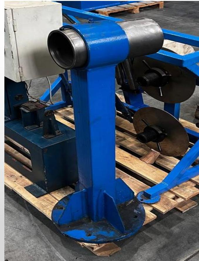
Предназначена для подачи кабельной заготовки вдоль выставленной оси технологической линии и предотвращения провисания между узлами оборудования.
