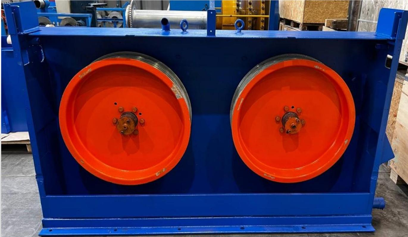
Тяговое устройство предназначено для равномерного натяжения и подачи готового изделия на приемное устройство.
