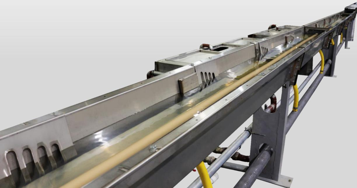
Система охлаждения служит охлаждения экструдированных кабелей погружением в воду однопроходной и многопроходной ванн охлаждения.
